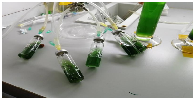
9-сурет – Виальдарға аргон газын толтыру барысы; Сутегі бөліну деңгейін анықтау мақсатында виальдарға 96% таза аргон газын жіберу
